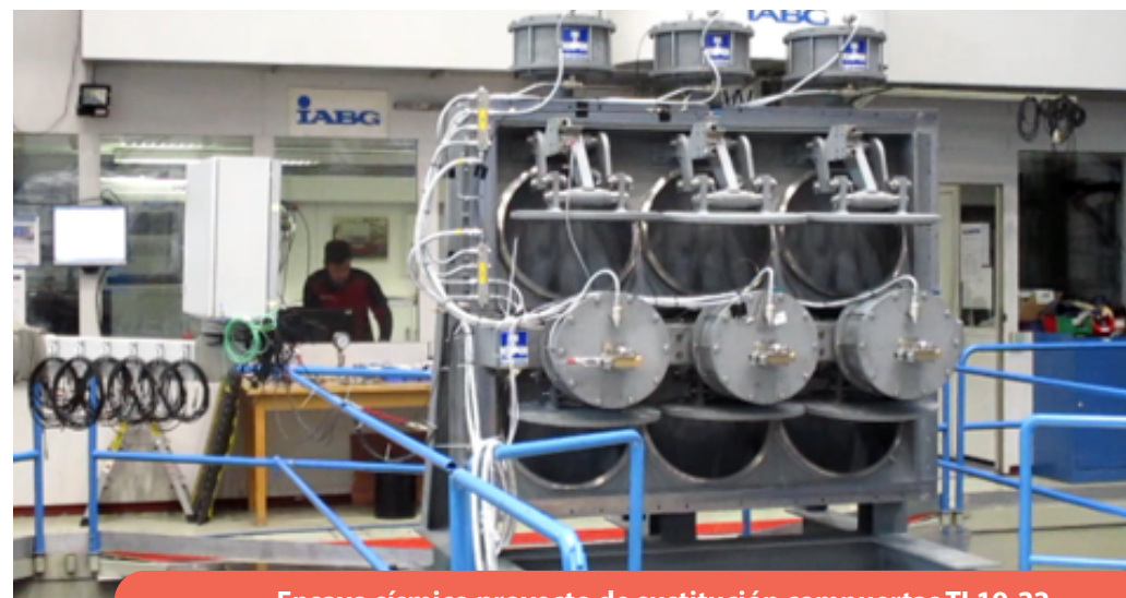
Ensayo sísmico proyecto de sustitución compuertas TL19-22
