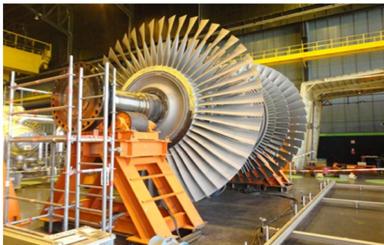
Rotor de turbina de baja presión
